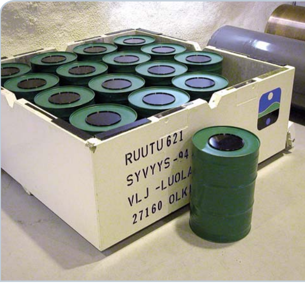
Osa kiinteistä voimalaitosjätteistä pakataan 200 litran tynnyreihin.
