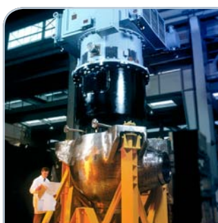
Pääkiertopumppu Jeumontin tehtaalla Ranskassa (N4, 1 500 MWe).
