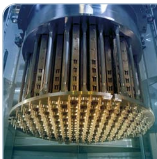
Reaktoripaineastian ylemmät sisäosat, (Chooz 1, Ranska).
