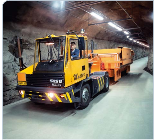
Erikoisajoneuvo kuljettaa jätepakkaukset Olkiluodon voimalaitosjäte- eli VLJ-luolaan.
