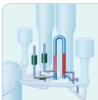
Primääripiiriin syötettävän lisäveden booripitoisuutta tarkkaillaan kahden- ja kolmen prosentin mittalaitteilla, jotka ohjaavat automaattista turvallisuustoimintaa.
