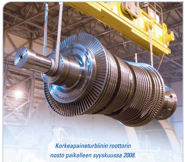
Korkeapaineturbiini on kaksivirtaustyyppinen, ja sen sisä- ja ulkopesä muodostuvat vaakasuunnassa jaetuista sisä- ja ulkopesärakenteista.
