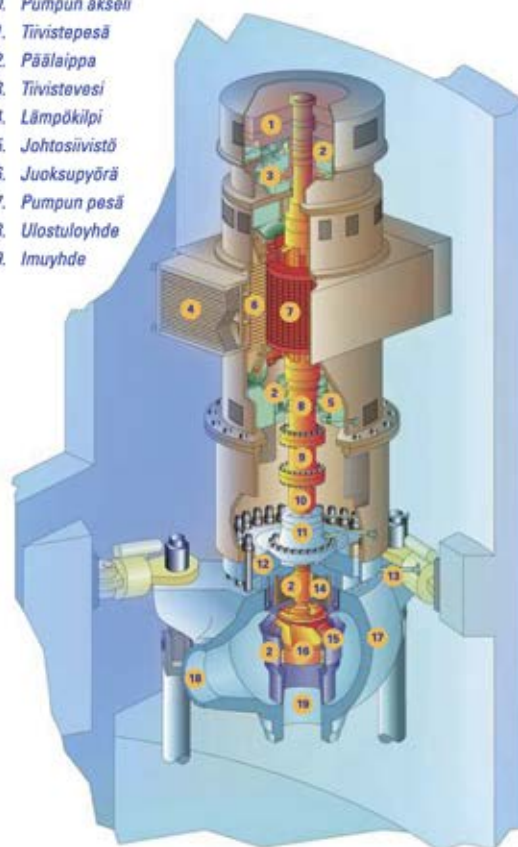
Kuva 12. Reaktorin pääkiertopumpun poikkileikkaus.
