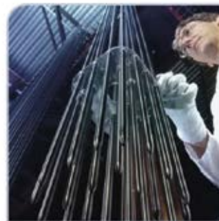
Reaktorstyrelementens fingersstyrstavar rör sig i styrrören inuti knippet. Samma styrrör används även för att placera instrumentering och neutronkällor.
