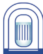
Dubbla betongväggar i den gastäta reaktorinneslutningen
