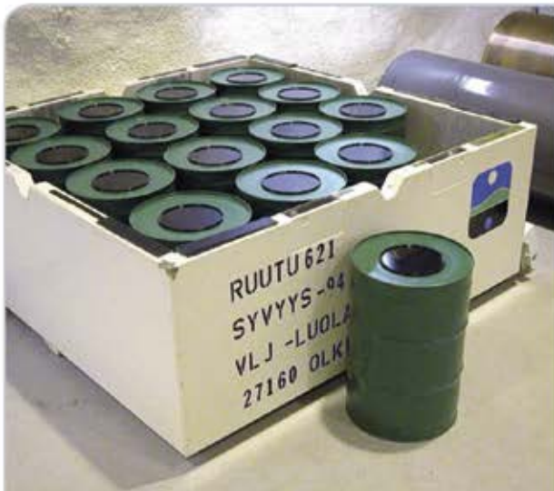
En del av det fasta kraftverksavfallet förpackas i 200 liters tunnor.
