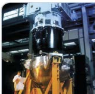
Huvudcirkulationspumpen på Jeumontfabriken i Frankrike (N4, 1 500 MWe).
