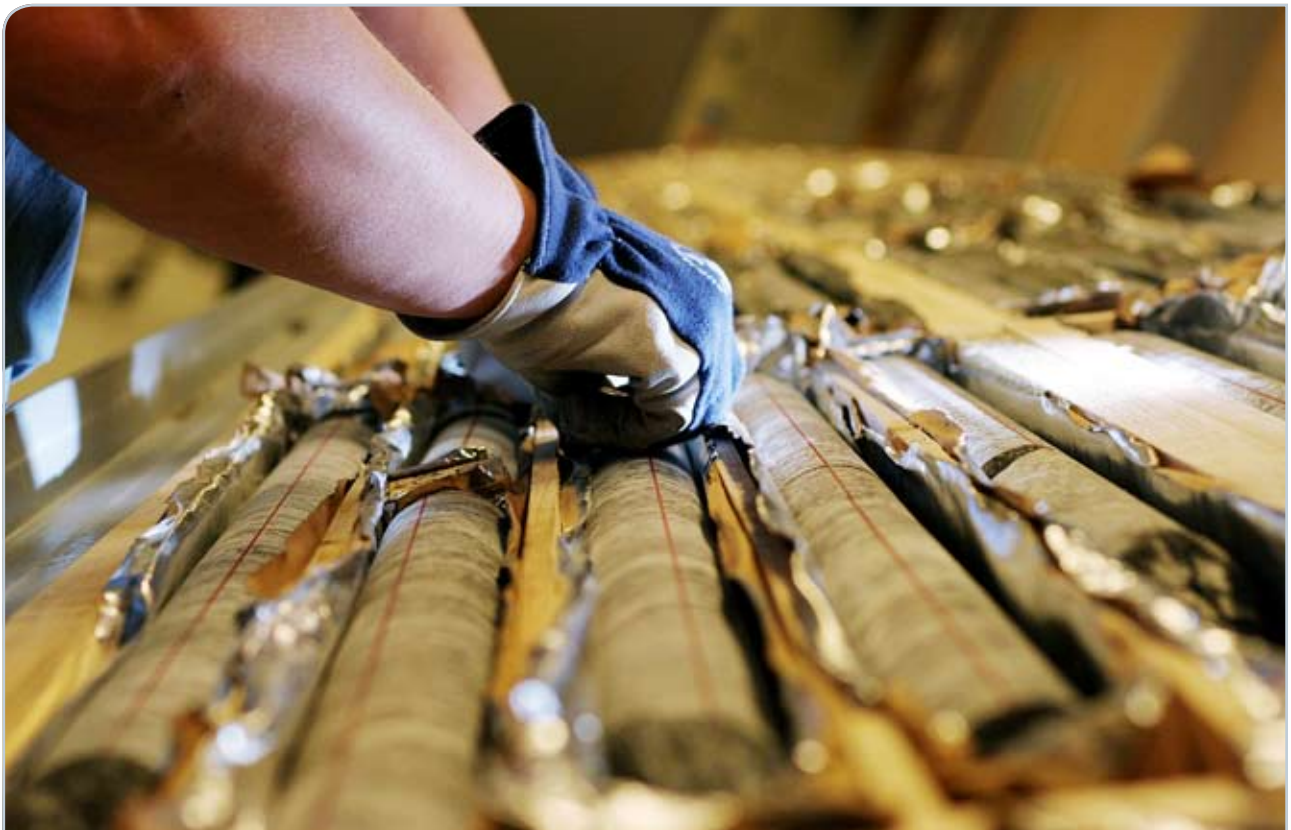
Kuva 9-9 Kallioperän ominaisuuksia tutkitaan muun muassa kairasydännäytteiden avulla. Kallioperästä Olkiluodossa kairattuja kairasydännäytteitä tutkitaan tuhansia metrejä (Posiva).
