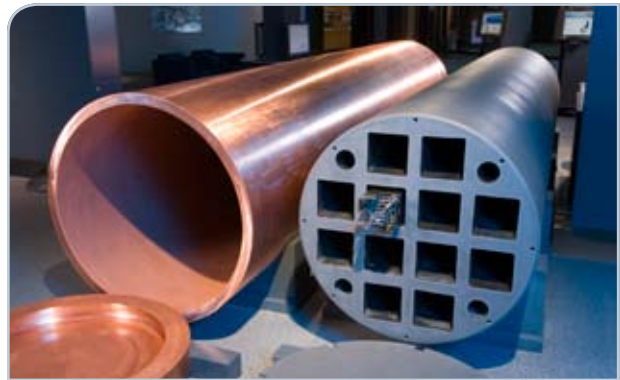
Kuva 9-7 Loppusijoituskapseli koostuu kuparisesta ulko-osasta sekä pallografiittirautaisesta sisäosasta. Loppusijoituskapselin sisälle mahtuu 12 OL1:n ja OL2:n käytettyä polttoainenippua kuten kuvassa tai neljä OL3-tyyppisen EPR:n polttoainenippua.
