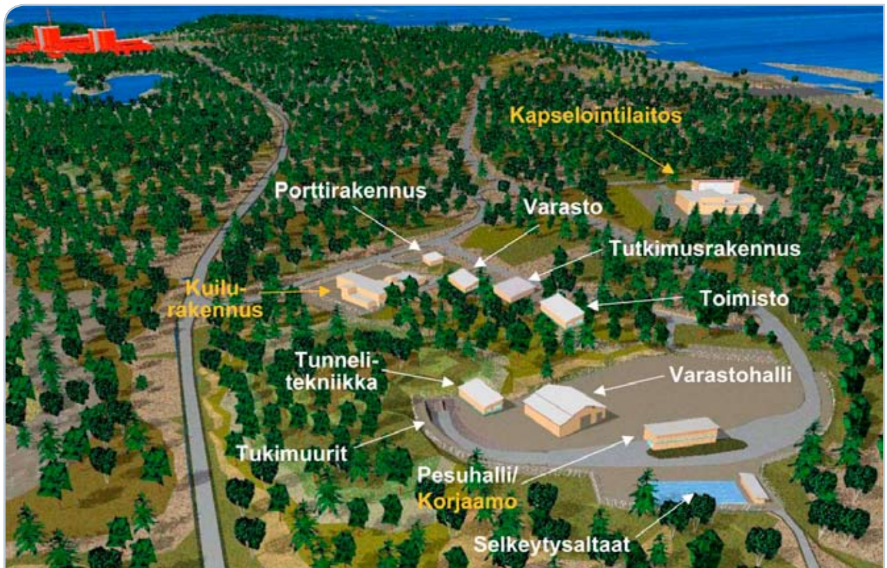
Kuva 9-5 Havainnekuva loppusijoitusalueen maanpäällisistä osista (Posiva).
