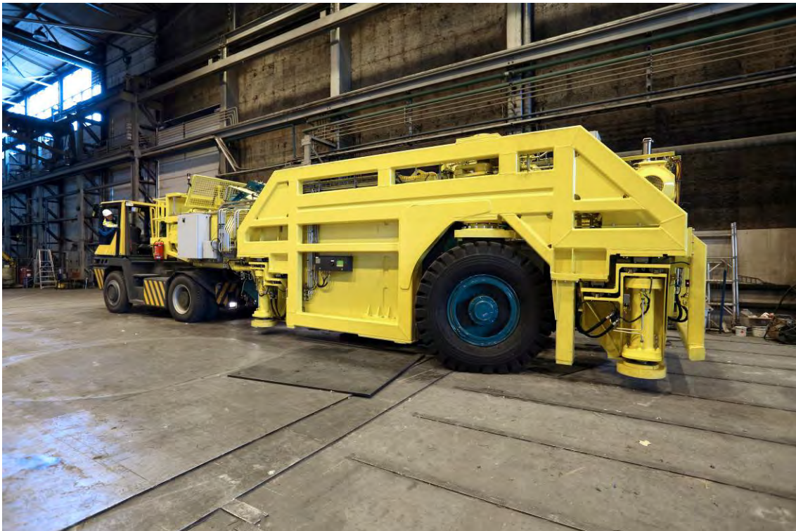
Kuva 5-1. Kapselin siirto- ja asennuslaitteen vuonna 2014 valmistunut prototyyppi.
