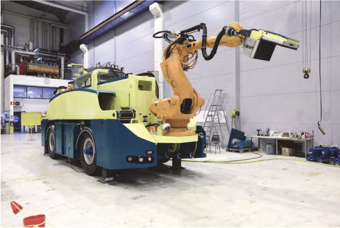
Kuva 5-6. Täyttömateriaalien asennuslaitteen prototyyppi.
