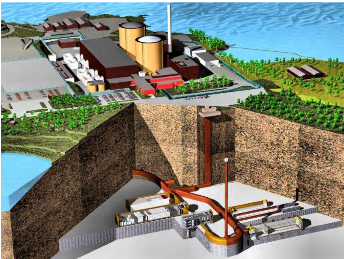
Kuva 2-1. Loviisan voimalaitoksen loppusijoituslaitos, VLJ-luola.
