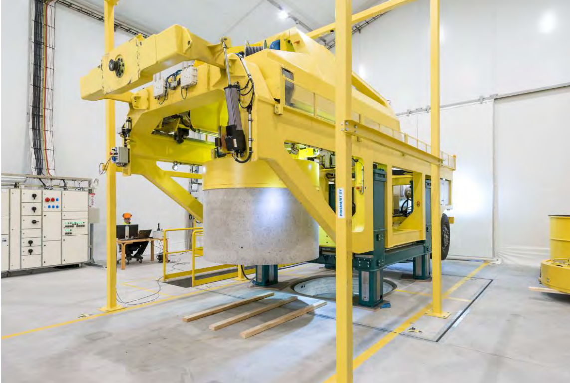
Kuva 5-2. Osana LUCOEX-projektia kehitetty puskurilohkojen asennuslaitteen prototyyppi testaushallissa.
