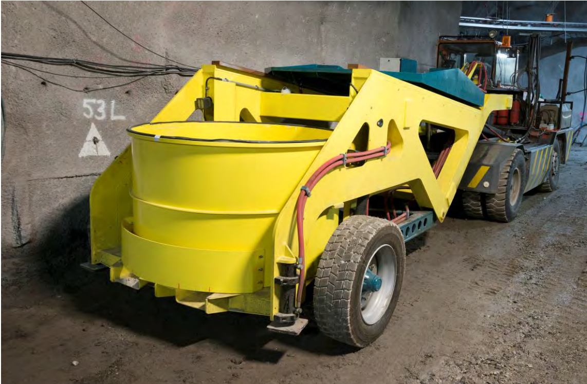
Kuva 5-4. LUCOEX-projektissa kehitetty puskurilohkojen kuljetuslaitteen prototyyppi.
