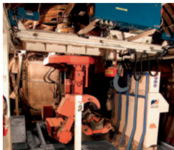
Poraus kone irrottaa uraanin kalliosta korkeapaineisella vesisuihkulla.
