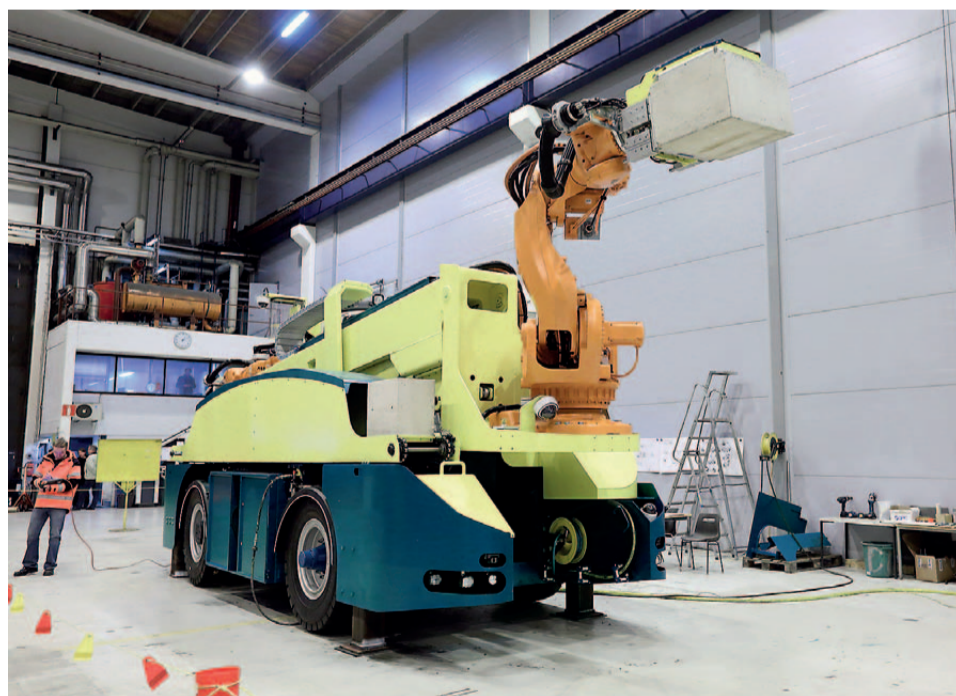
Kapselin siirto- ja asennusajoneuvoa käytetään loppusijoituskapselien siirtämiseen ja paikalleen asentamiseen. Posiva on testannut laitteen prototyypin maan päällä ja ONKALOsissa. Posivan järjestelmävastaava Jouni Tiainen (pikkukuva) sanoo, että testeillä osoitetaan laitteen toimivan tunneliolosuhteissa. Samaan aikaan Posiva tekee kehitystyötä loppusijoitustunnelin täyttömateriaalien asennuslaitteen osalta (alakuva).
