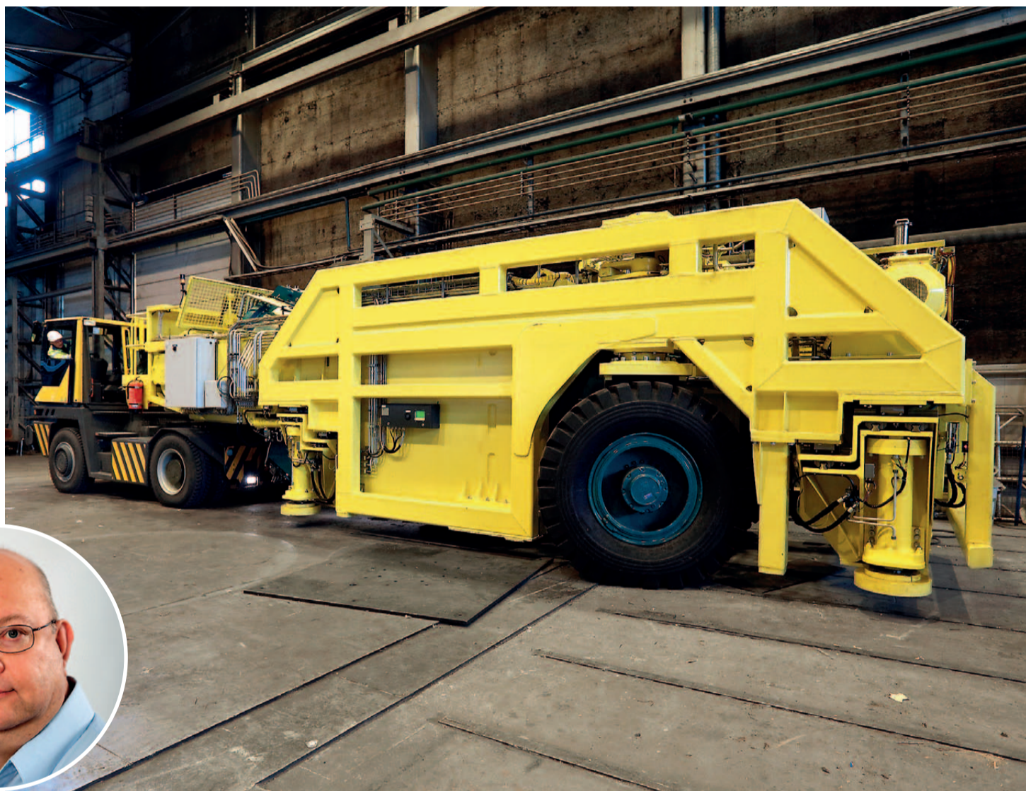
Kapselin siirto- ja asennusajoneuvoa käytetään loppusijoituskapselien siirtämiseen ja paikalleen asentamiseen. Posiva on testannut laitteen prototyypin maan päällä ja ONKALOsissa. Posivan järjestelmävastaava Jouni Tiainen (pikkukuva) sanoo, että testeillä osoitetaan laitteen toimivan tunneliolosuhteissa. Samaan aikaan Posiva tekee kehitystyötä loppusijoitustunnelin täyttömateriaalien asennuslaitteen osalta (alakuva).
