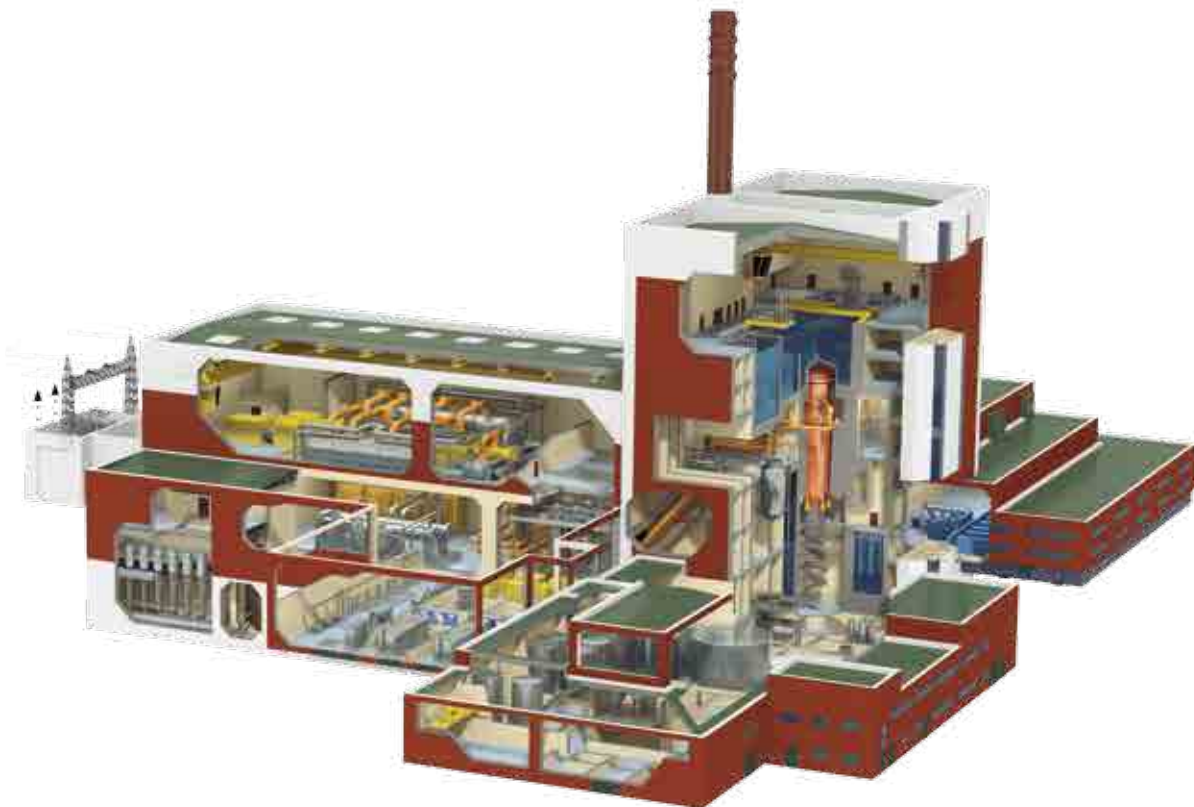
Bild 8. TVO:s kärnkraftverks anläggningsenheter Olkiluoto 1 och 2 är varandras kopior. På bilden visas en genomskärning av anläggningsenhetens utrymmen.
