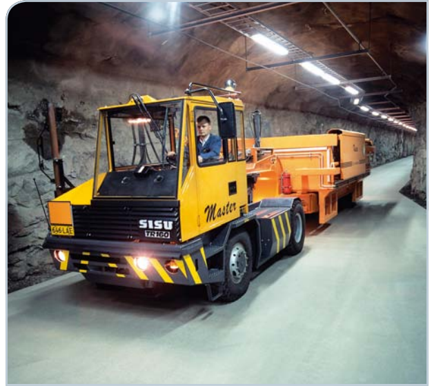
Erikoisajoneuvo kuljettaa jätepakkaukset Olkiluodon voimalaitosjäte- eli VLJ-luolaan.
