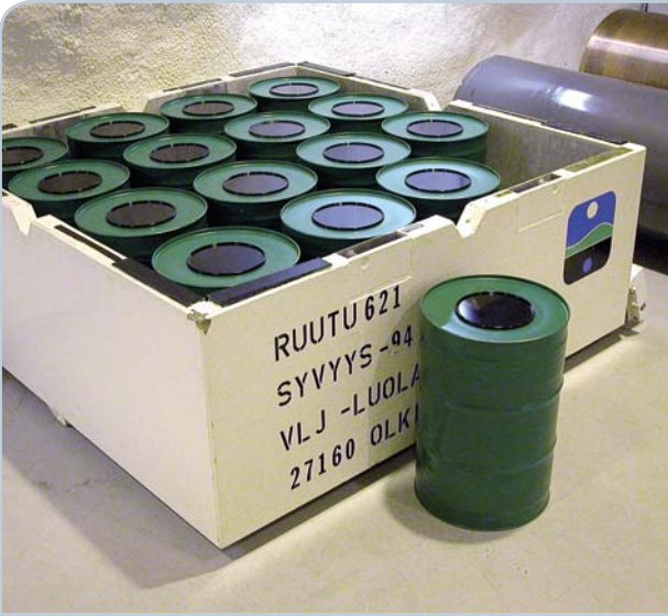
Osa kiinteistä voimalaitosjätteistä pakataan 200 litran tynnyreihin.
