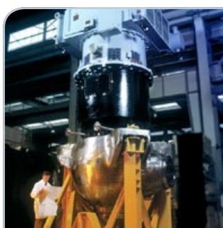
Pääkiertopumppu Jeumontin tehtaalla Ranskassa (N4, 1 500 MWe).
