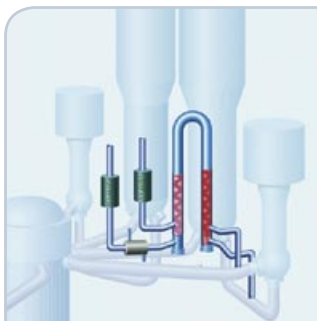
Primääripiiriin syötettävän lisäveden booripitoisuutta tarkkaillaan kahdennetuilla, jatkuvatoimisilla mittalaitteilla, jotka ohjaavat automaattista turvallisuustoimintaa.
