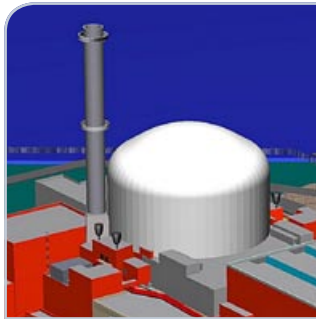
Poistokaasut johdetaan laitokselta viivästettyinä ja suodatettuina 100 metriä korkean piipun kautta ilmaan.
