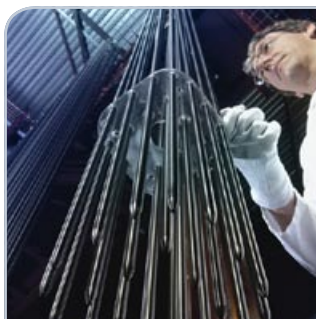
Reaktorin säätöelementtien sormisäätösauvat liikkuvat nipun sisällä olevissa ohjausputkissa. Samoja ohjausputkia käytetään myös instrumentoinnin ja neutronilähteiden sijoittamiseen.
