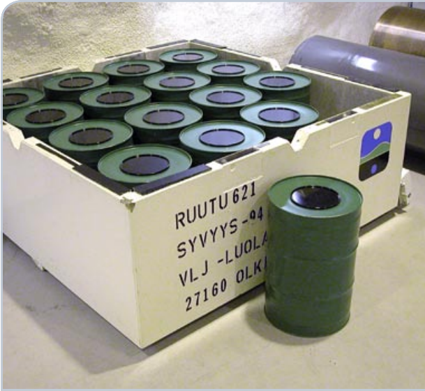
Kiinteät voimalaitosjätteet pakataan 200 litran tynnyreihin.
